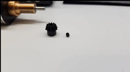
5) Při upevňování pastorku je velmi důležité použít správné lepidlo. Mělo by se jednat minimálně o červený Loctite. Můžete však použít i jiná silná lepidla. Nepoužívejte modré lepidlo na závity, protože není dotečně silné. Vezměte ozubené kolo pastorku, podržte ho vzhůru nohama a do otvoru naneste kapku lepidla tak, aby se dostalo do pastorku. Po nanesení malé kapky setřete přебytéčné množství ze spodní části pastorku.
