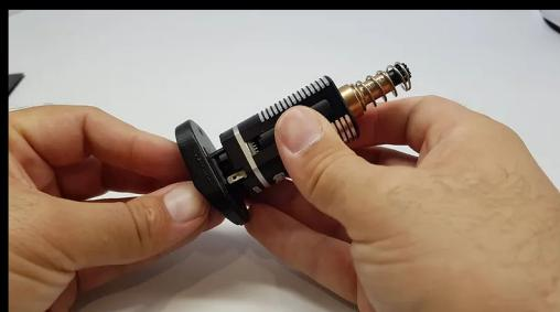
9) Tako provedená kontrola uložení zajistí správný úhel záběru při montáži motoru do zbraně. Před použitím ve vaší zbrani provedte na pažbici úpravu nebo pilování, které je nutné. Po dokončení tohoto posledního kroku jste připraveni k montáži motoru.
