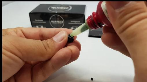
6) Při nasazování pastorku na hřídel je důležité držet motor hřídel směrem dolů, aby se použitý Loctite nedostal do ložiska na krytu hřidele. Pokud se tak stane, může dojít k zadření ložiska během provozu.
