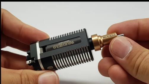
3) Druhým krokem je odstranění malých kousků smršťovací bužírky z výstupků konektoru na zadní straně motoru. K tomu použijte malý plochý šroubovák nebo jiný vhodný nástroj. Při tomto úkonu budete opatrní, abyste nepoškodili výstupky konektoru na motoru. Po odstranění můžete smršťovací pásky zlikvidovat.
