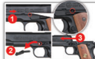
1. (図のとおり)、スライドを後ろにずらして切り欠きをあわせます。 2. スライドストップを抜き取ります。 3. 前にずらしてスライドを抜きます。
