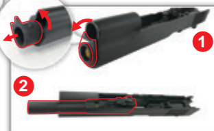
1. Retournez la glissière et tournez le manchon dans le sens antihoraire pour le retirer. 2. Retirez le canon.
